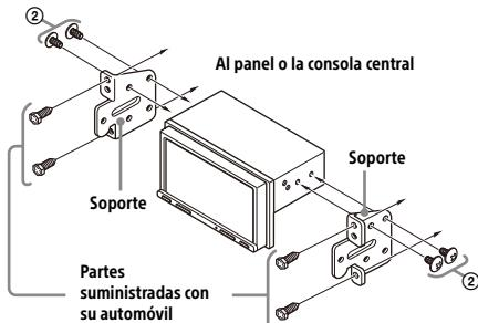
Al montar esta unidad en los soportes preinstalados de su automóvil, use los tornillos para el montaje ② en los espacios para tornillos correspondientes según su automóvil: T para TOYOTA y N para NISSAN.
